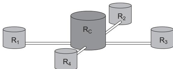
As ligações entre o reservatório central e os auxiliares são feitas por canos cilíndricos com 0,10 m de diâmetro interno e 20 m de comprimento, conectados próximos às bases de cada reservatório. Na conexão de cada um desses canos com o reservatório central há registros que liberam ou interrompem o fluxo de água.
